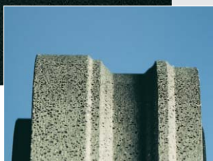
STROH-Abrichtrolle zum Schleifen der Laufbahnen einer Linearführung.
